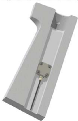
Obr. 3 Řez klínem stroje Hatebur s integrovaným senzorem přetvoření 4dot SMT
