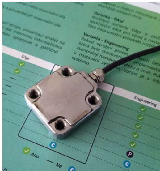
Obr. 4 Senzor přetvoření 4dot SMT, rozteč závitových otvorů 23 mm, hlavní rozměry 33×47×10 mm, průměr drátu 3,2 mm.
