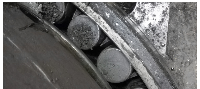
Pomaloběžné ložisko po dlouhodobé poruše mazání
