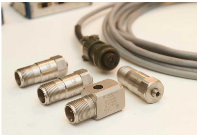
Obrázek 2 Jednoosý piezoelektrický akcelerometr s vestavěnou elektronikou (IEPE) vhodný pro použití na kováčích lisech.
