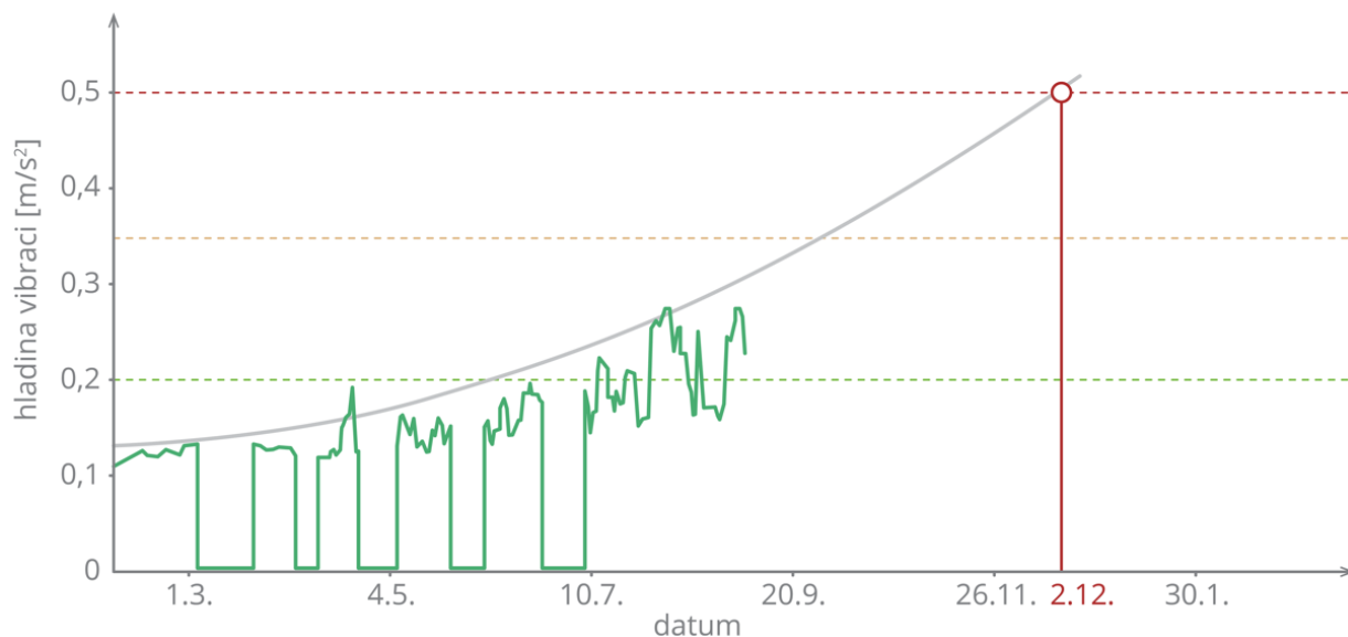
Graf 2 Křivka sledující kondici ložiska předlohy, nastavené limity – zelená (dobrý stav), oranžová (bdělost) a červená (riziko poruchy), šedá křivka je aproximací křivky kondice ložiska pro odhad zbytkové životnosti ložiska.
