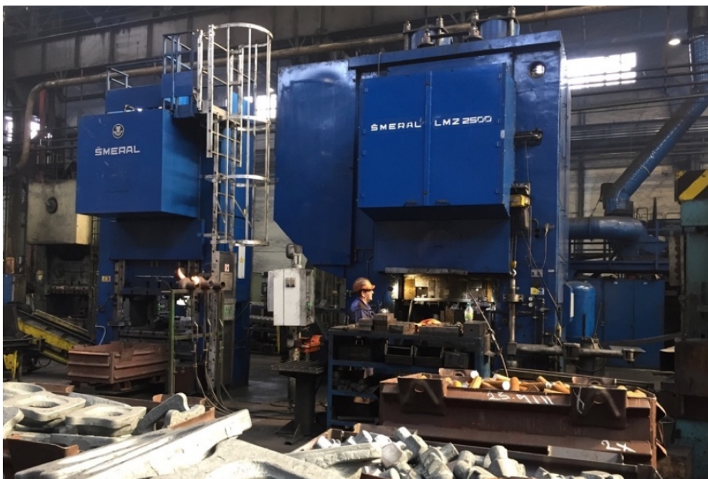
Obrázek 3 Na lisu LMZ 2500 jsou kovány různé druhy výkovků. Zároveň jsou v okolí lisu další kovací lisy, které ovlivňují vibrace samotného stroje, a tím i sledování kondice ložisek lisu.
