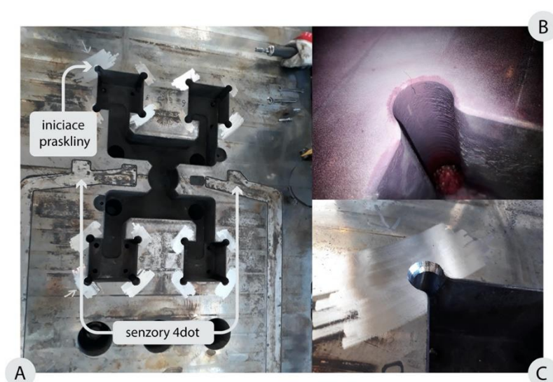
Obrázek 3 Inspekce poškozeného upínače nářadí. Praskliny zpravidla vznikají v rozích otvorů pro vyhadzovací mechanismus (A). V tomto případě byla lokalizována rozvíjející se prasklina (B), kterou bylo možné vybrousit (C) a tím prodloužit životnost upínače.
